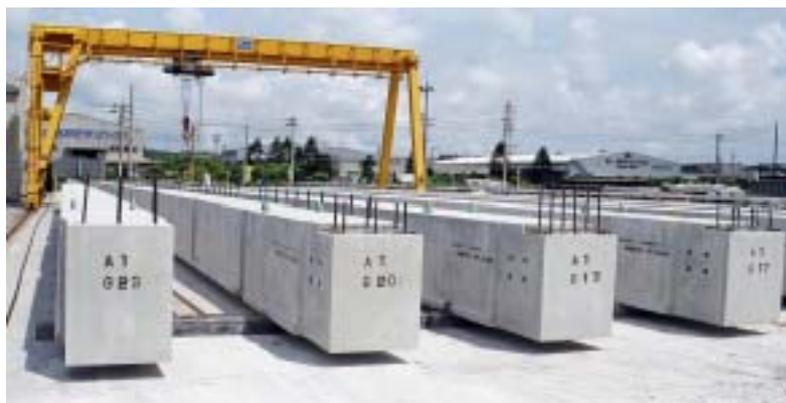
本製品は、JIS A5373 プレテンション方式によって製造する道路橋用のプレテンションスラブ桁です。JIS A5373 を基準に「道路橋示方書・同解説」にもとづく塩害対策を考慮しており、桁の長さに応じて充実桁と中空桁にわけられます。
