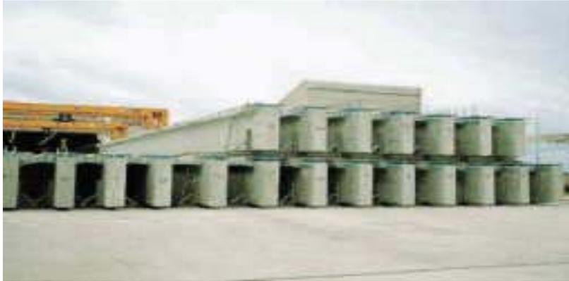
本製品は、JIS A5373 プレテンション方式によって製造する道路橋用のプレテンションT桁です。JIS A5373 を基準に「道路橋示方書・同解説」にもとづく塩害対策を考慮し、各部寸法を決定します。
